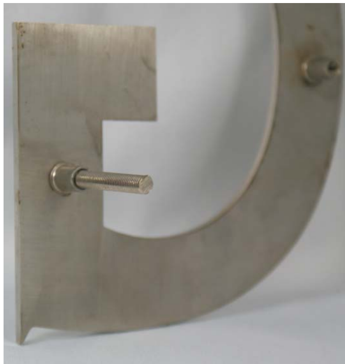
Var. C: Innengewindebolzen mit Gewindespille (max. M5, Länge variabel) -für V2A -für Messing, Kupfer, Alu bis Dicke 6mm -zum einkleben in die Wand (Bolzen dient gleichzeitig als Abstandshalter)
