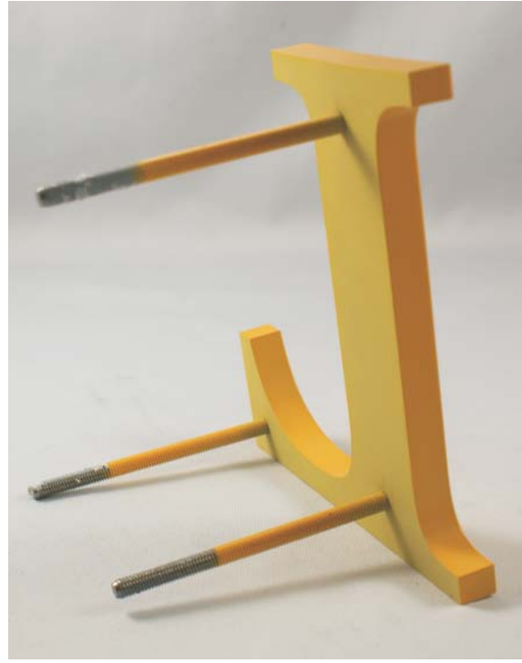
Var. B: Gewindespillen (Länge variabel) -für Messing, Kupfer, Alu ab Dicke 8mm -zum einkleben in die Wand (Abstandshalter können mitgeliefert werden)
